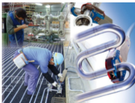
图1 封闭式焊接机头在现场的应用
