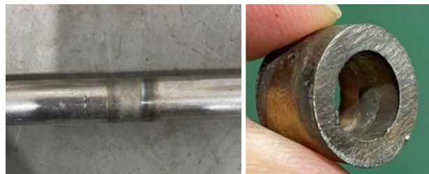
图 6 焊缝成形效果
